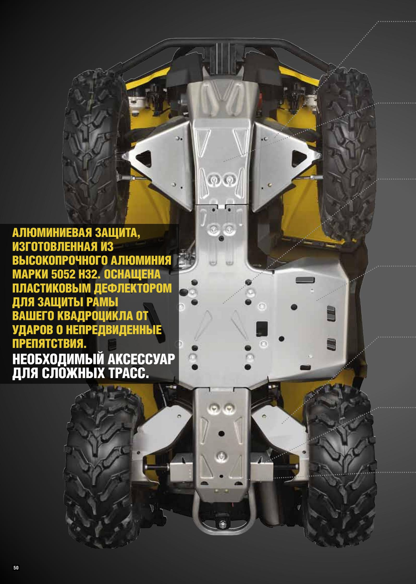
**АЛЮМИНИЕВАЯ ЗАЩИТА, ИЗГОТОВЛЕННАЯ ИЗ ВЫСОКОПРОЧНОГО АЛЮМИНИЯ МАРКИ 5052 H32. ОСНАЩЕНА ПЛАСТИКОВЫМ ДЕФЛЕКТОРОМ ДЛЯ ЗАЩИТЫ РАМЫ ВАШЕГО КВАДРОЦИКЛА ОТ УДАРОВ О НЕПРЕДВИДЕННЫЕ ПРЕПЯТСТВИЯ. НЕОБХОДИМЫЙ АКСЕССУАР ДЛЯ СЛОЖНЫХ ТРАСС.**
